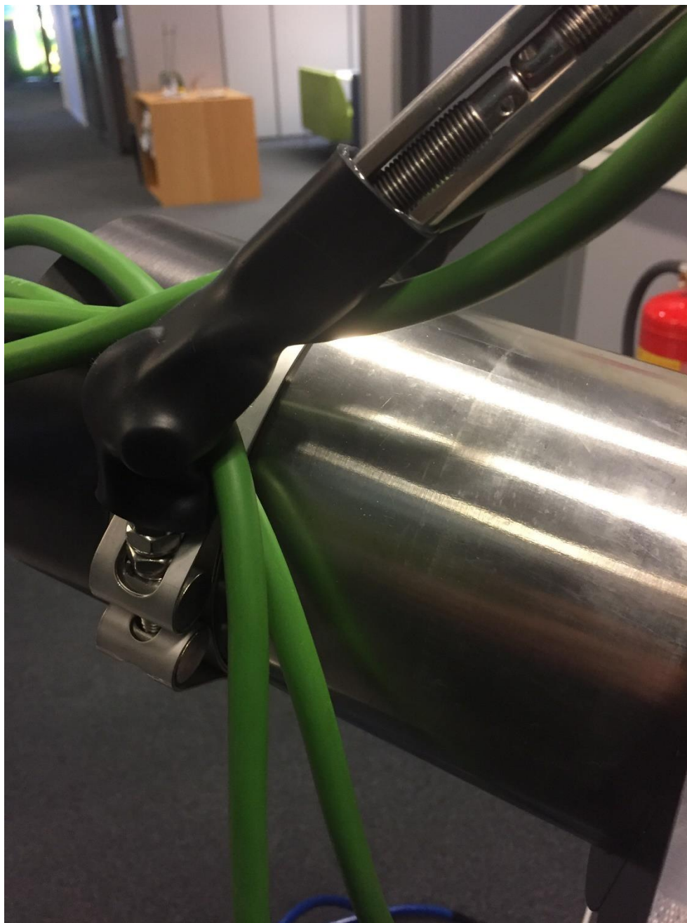
Figur 3: Beskyttelsesdeksel i sort POM rundt konnektor bak på UHI
